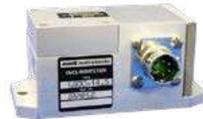
La seguente procedura deve essere utilizzata per livellare una superficie in due direzioni, da sinistra a destra e da davanti a dietro, utilizzando un inclinometro Jewell Instruments calibrato in produzione. Se un processo richiede una superficie livellata diversa dallo standard, seguire questa procedura per livellare la superficie entro i requisiti forniti.
